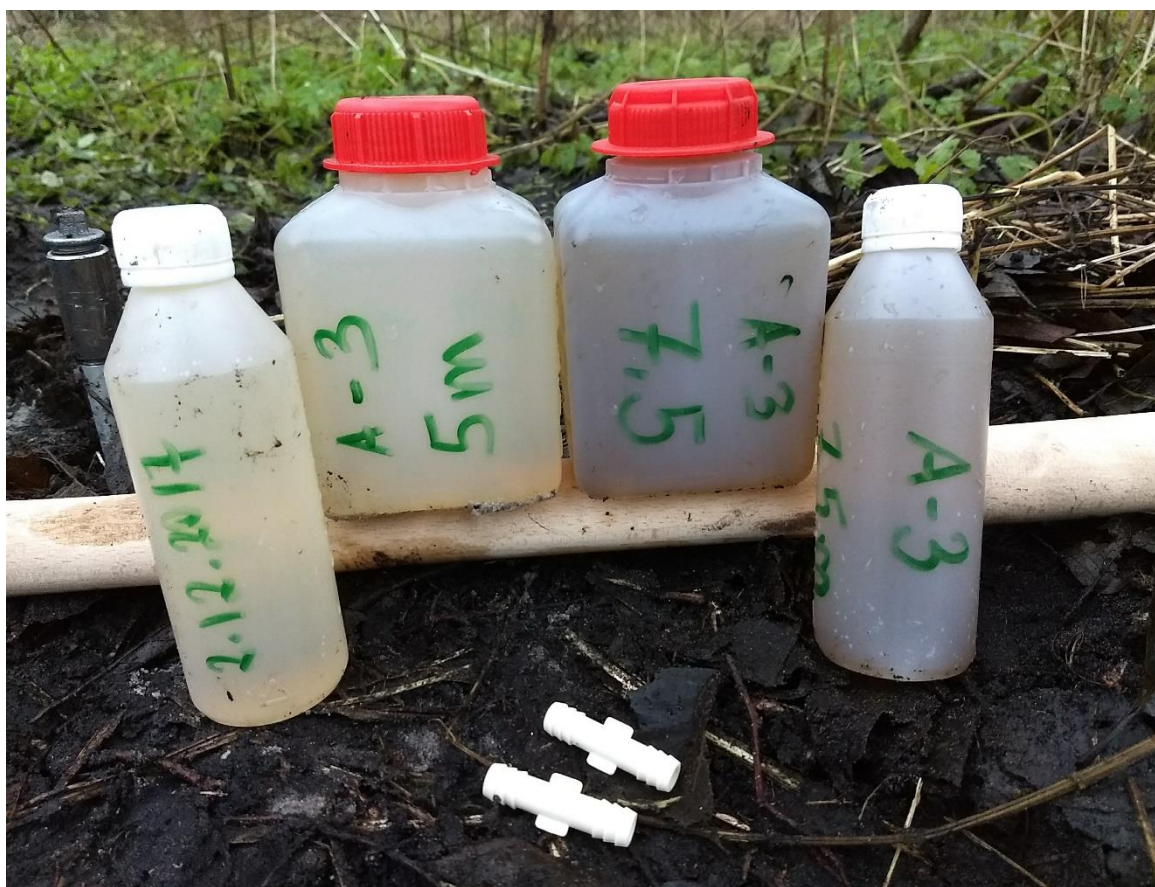
próbka wody z piezometru AGH-3 (większe zanieczyszczenia dla głębszej strefy poboru)
